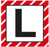
Sicherheitsstaubsauger der Staubklasse L dürfen nur bei Stäuben eingesetzt werden, die als leicht gefährlich betrachtet werden. In diesem Fall müssen keine Luftgeschwindigkeiten bei dem Sicherheitsstaubsauger gemessen werden. Besondere Anforderungen an die Filterung oder die Entsorgung bestehen nicht. Beispiele: Stäube aus Gips, Kalk und Glimmer
