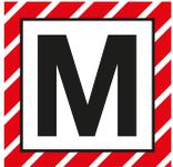
Staubklasse M muss bereits hohe Anforderungen an die Filterung sowie eine staubarme Entsorgung und eine Messung der Luftgeschwindigkeit im Sicherheitsstaubsauger erfüllen. Beispiele: Stäube aus Kupfer, Mangan oder Holz.
