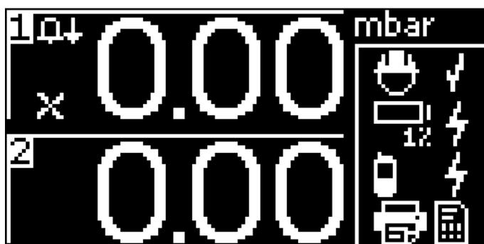
Der Status wird rechts im Messbildschirm angezeigt. Wenn eine Alarmsituation eintritt, wird hier das Symbol 🚫 angezeigt und VAC LTE-M lässt ein akustisches Alarmsignal ertönen. Durch Drücken auf das Symbol wird der Alarm quittiert und das Alarmsignal unterdrückt.
