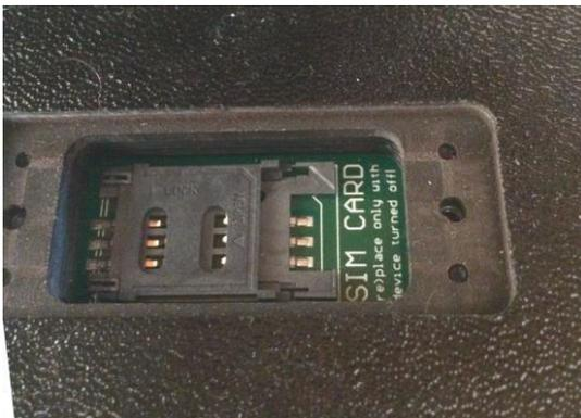
Setzen Sie die SIM-Karte in den Halter und lassen Sie ihn wieder nach unten sinken. Durch Schieben des Halters nach rechts wird die SIM-Karte gesichert:
