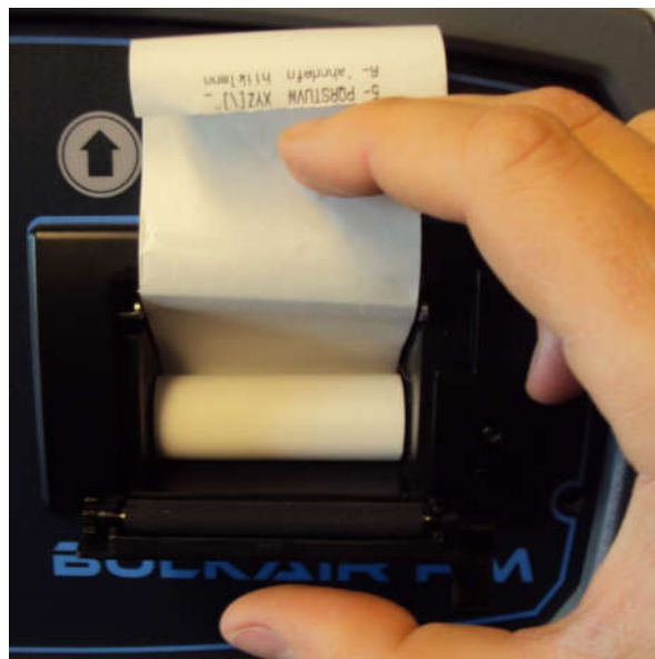
Abbildung 7 - Einsetzen der Papierrolle
