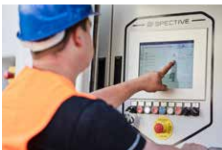
Das intuitive 12-Zoll-Touchpanel vereinfacht das Arbeiten an der Maschine. Alle Funktionen sind auf einen Blick erkennbar, klare Symbole weisen den Weg.
