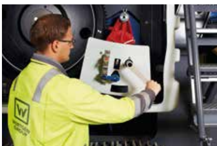
Das ausgezeichnete System „Lock & Turn“ sorgt für höchste Sicherheit beim Schlagleistenwechsel oder Lösen von Verbrückungen.
