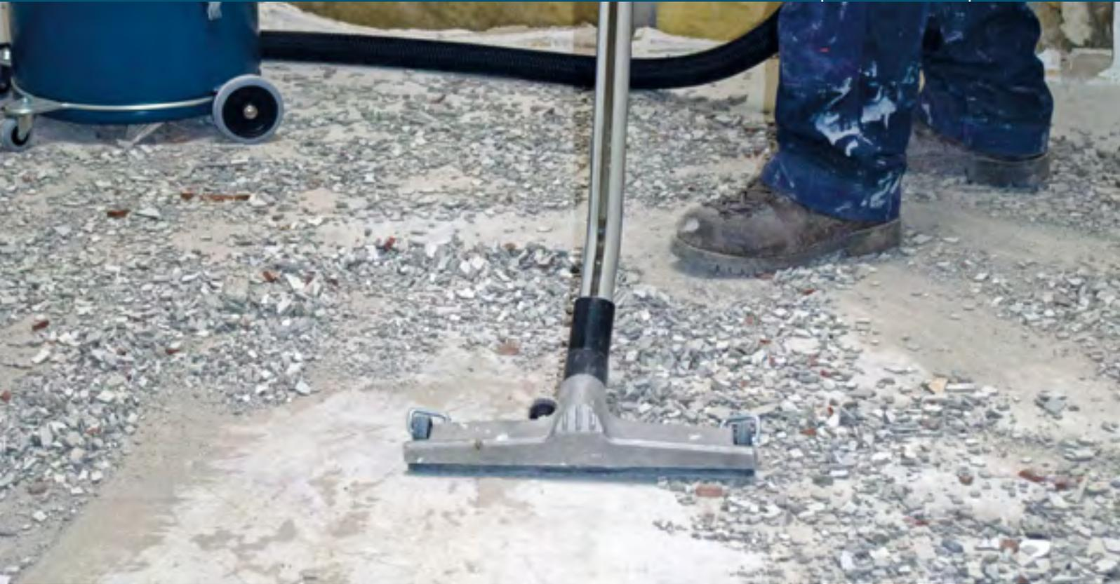
Unsere Industriesauger der Staubklasse H können für Schleifmaschinen, Fräsen, für Reinigungsarbeiten und viele weitere Einsätze verwendet werden. Sie sind mit energiesparenden ECO-Motoren ausgestattet und bei ihrem Einsatz kann von Asbest bis Zement alles gesaugt werden.
